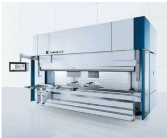
Das Bild zeigt eine der Neuschaffungen: eine große Biegemaschine mit der Blechteile bis zu einer Länge von 4,42 Metern gekantet werden können.
